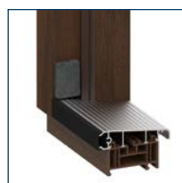
Тёплый порог из алюминия и ПВХ с термической преградой, подреёмной перемычкой из ПВХ и виндстоппером
