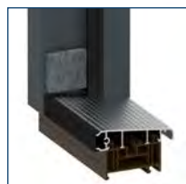
Тёплый порог из алюминия и ПВХ с термической преградой, подпроёмной перемычкой из ПВХ и виндстоппером
